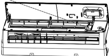
Etape 4. Desserrez la vis du couvercle du boîtier électronique et retirez le couvercle.
