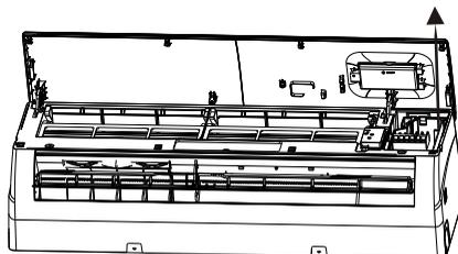
Insérez le connecteur du module Wi-fi dans le connecteur CN16 du PCB
