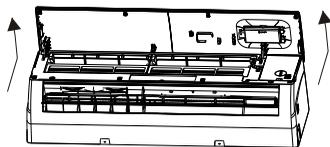
Etape 2. Trouvez le support de module Wi-Fi sur le panneau ou le châssis, utilisez une vis ST3.5x9.5 ou équivalent pour fixer le module Wi-Fi
